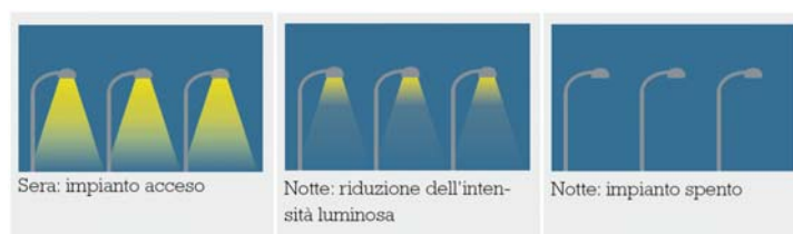
Figura 4 Riduzione dell'intensità luminosa o spegnimento durante le ore senza necessità di illuminazione ( www.topten.ch/ip )
