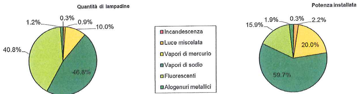
Figura 1 Divisione in percentuale delle tipologie di lampadine installate secondo quantità (sinistra) e potenza rispettiva (destra) a novembre 2012. Con i colori rossastri sono rappresentate le tipologie che spariranno dal commercio europeo nel 2015, in totale circa un decimo. Alcune lampadine ai vapori di sodio installate sono Plug-in (sostitutive di quelle ai vapori di mercurio). Anche queste lampadine spariranno dal commercio europeo nel 2015.
